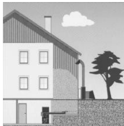
Hackgutlagerung in bestehendem Silo. Hacken direkt in den Lagerraum bzw. mit Gebläsebeschickung.
